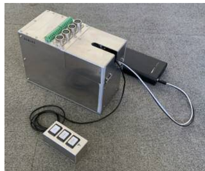
SENJAS-LTS24X (SJ-LTS24X) デスクトップタイプ 4chブリッジ入力+8ch歪構成 外部PCとUSB接続にて使用 注) 押しボタンは含みません
