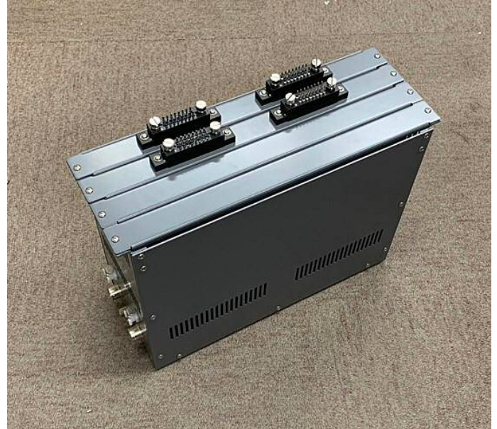
128chセンサユニットに、32chカードを2個格納し64chとした構成
