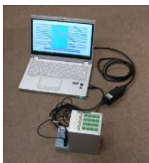
SENJAS-LTS24SA (従来型SJ-LTS24SA) デスクトップタイプ 4ch電圧+歪16ch構成
