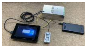
SENJAS-LTS24L (SJ-LTS24L) 小型ロガータイプ 歪8ch構成
