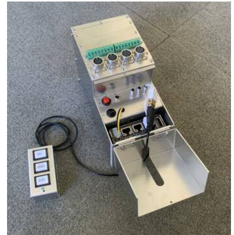
SENJAS-LTS24XL (SJ-LTS24XL) デスクトップ使用時 (外部PCをUSB接続) ロガー使用時 (内部PCでの単体計測が可能) なお、従来型SENJAS-LTSからのアップグレードも可能です。
