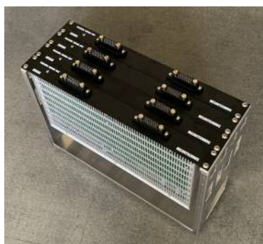
32chセンサユニット×4 128ch 構成 (専用簡易ラック装着)
